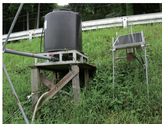
写真3 日射制御型拍動自動灌水装置の設置例
