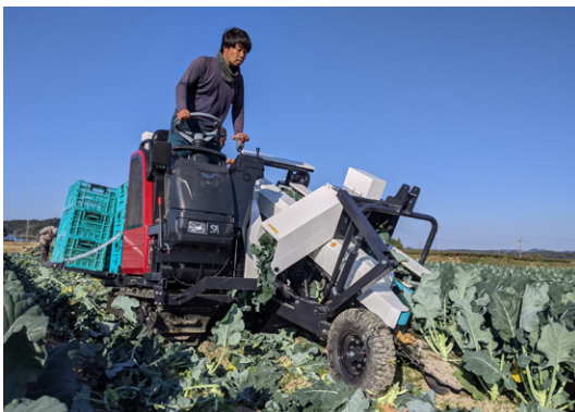
写真2 ブロccoliー自動収穫機 (写真提供：株式会社鈴生)
