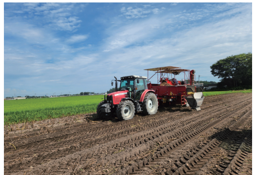
写真7 大型のポテトハーベスターによるジャガイモ収穫作業
