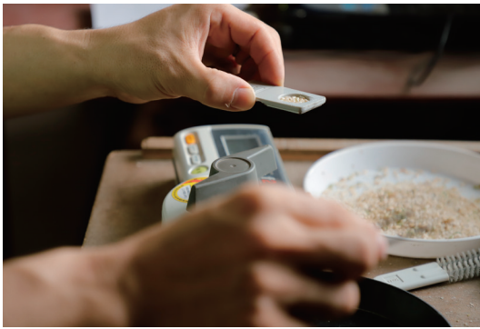
図2 ケットの手动水分計で乾燥機の玄米水分を計測 (写真撮影：依田賢吾)
