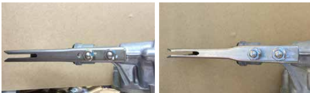
図1 慣行苗かき取り爪（左）と密苗対応爪（右）
