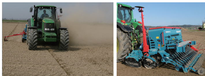
図1 北海道岩見沢地域での乾田直播。垂直爪のハローによる耕起と，ドリルによる播種が同時にできるコンビネーションハローシーダー。乾田直播のみならず，ムギ・ダイズなど穀類の播種に幅広く使用できる。作業速度は毎時6～10kmで，1ha以上の大区画圃場なら1日8～10haの播種作業が可能
