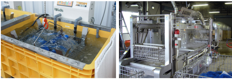
図2 イネ種もみ温湯消毒の処理装置。簡易な小型（左）から全自動タイプの大型（右）まで
