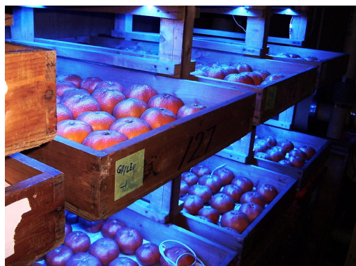
写真2 GP剤散布と青色LED光照射による腐敗果抑制試験の様子
