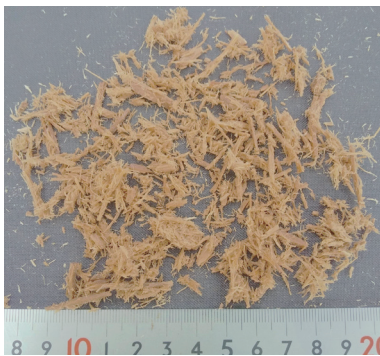
写真5 木材チップをフルボ酸に浸漬させた資材 「DW ファイバー」(DAIKEN) (写真提供：佐藤智博)
