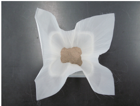
図6 ナイロンメッシュで迅速かつ簡便に砂含量を測定。試料を巾着状に包み、流水中で揉みほぐして粘土とシルトを洗い出し、前後の秤量差を計測
