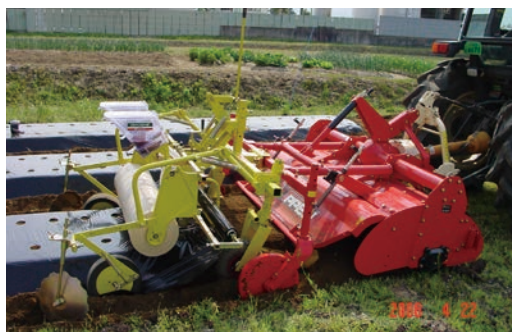
第4図 耕うん同時うね立て・播種・マルチ作業（左）と、直播エダマメの初期生育（右）
