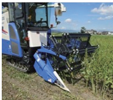
写真2 大豆コンバインによるゴマの蒔による収穫
