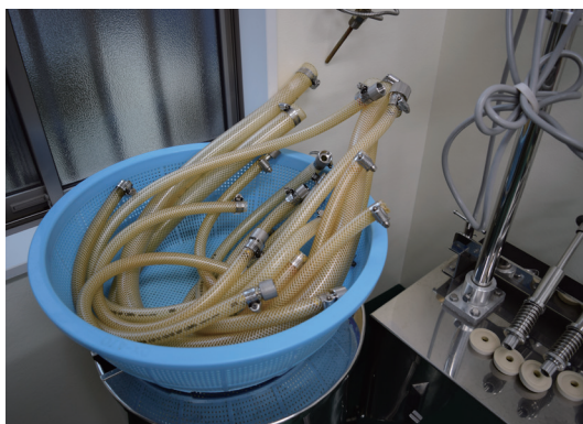
写真2 充填装置も最小単位まで分解できる機器を
