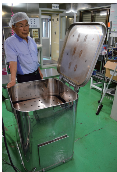
写真13 手間の軽減を考えて改造した搾汁機
