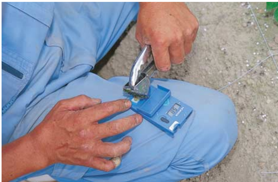
硝酸イオンメータを使って、ナガイモの葉の硝酸を測る。「トラクタ - にばかり乗ってないで、畑に降りて作物をよく見ると、農薬も肥料も減らせます」（*）
